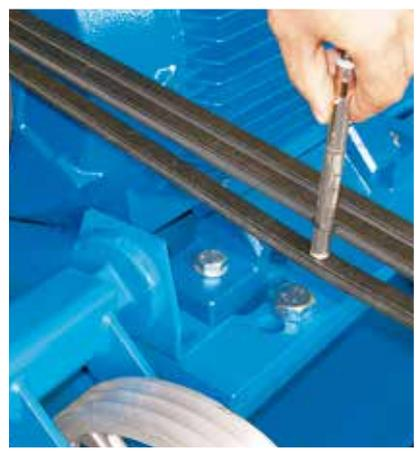
Druckfeder-Tester von **Gates**
