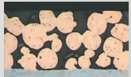
Abb. 4: Zustand am Ende des Einlaufvorgangs. Die Bronzeschicht beginnt zu tragen.
